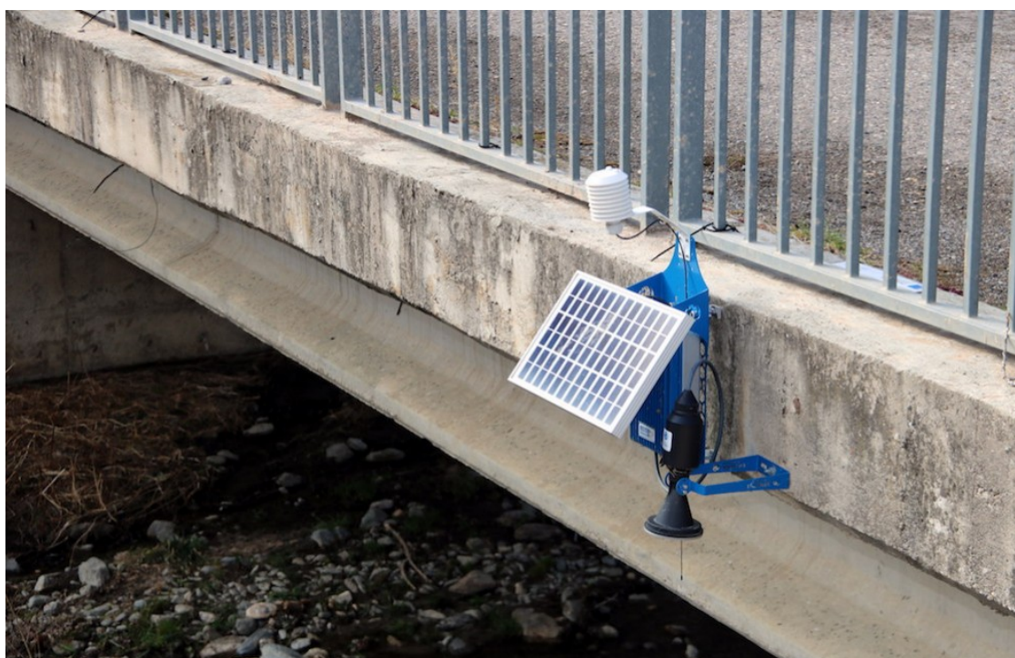
Imatge d'un aparell que mesura el cabal dels rius | ACN
